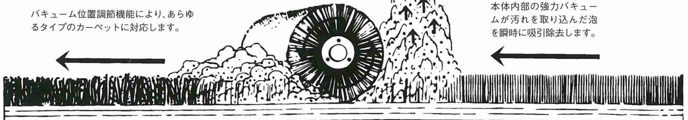
本体内部の強力バキュームが汚れを取り込んだ泡を瞬時に吸引除去します。
