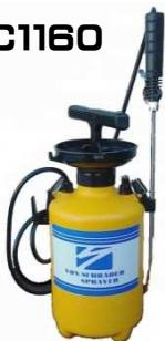
カーペットについた油、グリース、ワックス、飲食物などの強い汚れを簡単に、しかも効果的に除去するための前処理スプレー洗浄方式。特殊扇形ノズルで均一に噴射し、溶剤の無駄をはぶき作業能率を高めます。
